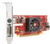
La tarjeta gráfica ATI Radeon HD 4550 DH PCIe x16 proporciona un bajo perfil, una tarjeta gráfica adicional PCI Express x16 basada en el procesador de gráficos ATI RV710. Estas tarjetas admiten salida de vídeo para dos pantallas mediante sus conectores de salida de TV y DMS-59.
